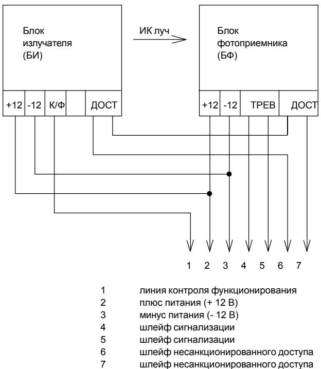
способности извещателя при его установке в длинных и узких коридорах, вдоль стен (пола, окон), при наличии посторонних предметов, расположенных в непосредственной близости от оптической оси - воображаемой прямой, соединяющей между собой БИ и БФ, ИК луч 1 на рисунке ниже.
