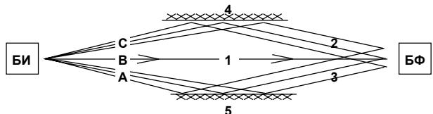
При этом, в зависимости от отражательной способности ограждающих поверхностей (или предметов) 4 и 5, энергии переотраженных ИК лучей может оказаться достаточно для сохранения дежурного режима при перекрытии прямого ИК луча 1.
