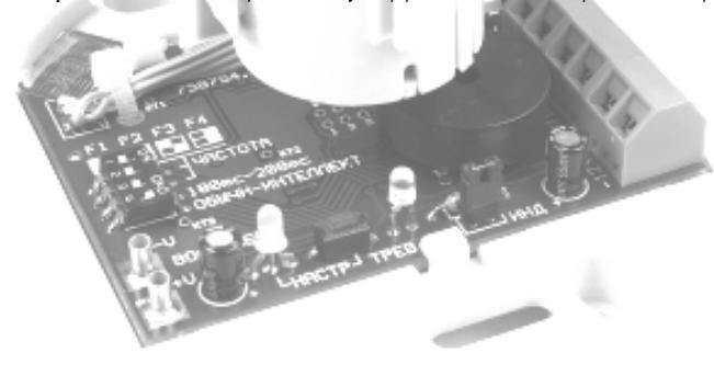
1.4.8 При включении режима "Настройка" (кнопка НАСТР в БФ) включается световой индикатор НАСТР, который индицирует уровень ИК сигнала на оптическом окне БФ, что значительно упрощает юстировку блоков извещателя и позволяет провести ее без применения внешнего вольтметра.
